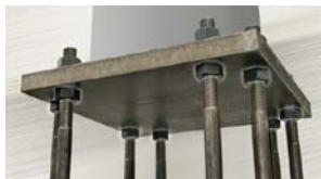
ベースプレート下にナットを配置
