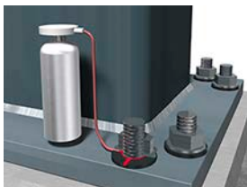
ボルト孔にシール材注入
